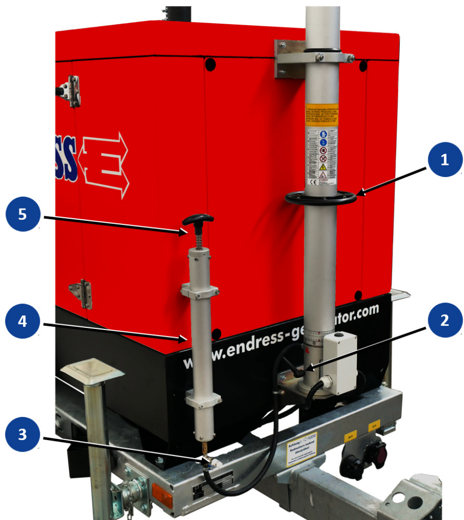
Abb. 7-24 Lichtmasteinrichtung mit Druckluftantrieb über Handpumpe
