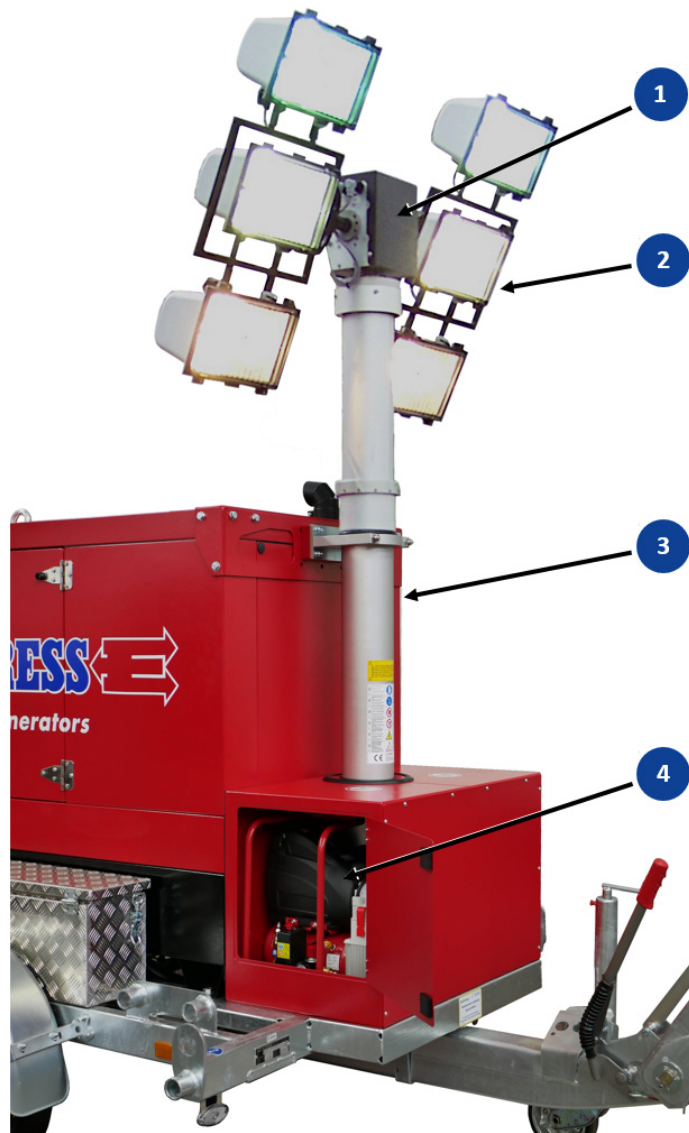
Abb. 7-23 Lichtmastanlage mit Druckluftantrieb über Kompressor
